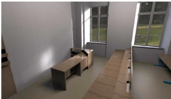
Vietavná skříň - rutno doměti po demontáži stávající skříňní! Materiál laminová deska opatřená ABS hranou - Dub. Všechny bočníky bude nutné na místě udělat otvory pro kabeláž sceneri. Příliš pro sceneri na akvizisních pozicích. Dveře uzamykatelné univerzální klíčem. Otvory bude nutné překrýt okličkami po celém obvodu. Počet kusů: 1
